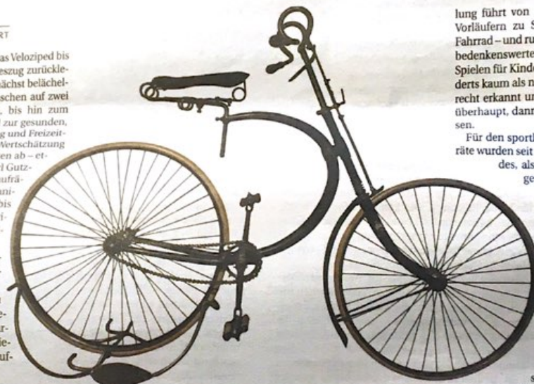
„Hirondelle“, ein Sicherheitsniederrad mit halbmondförmigem Rahmen und gedrehtem Lenker sollte aufgrund seiner besonderen Federungseigenschaften überzeugen. Foto: Klaus Reckert
